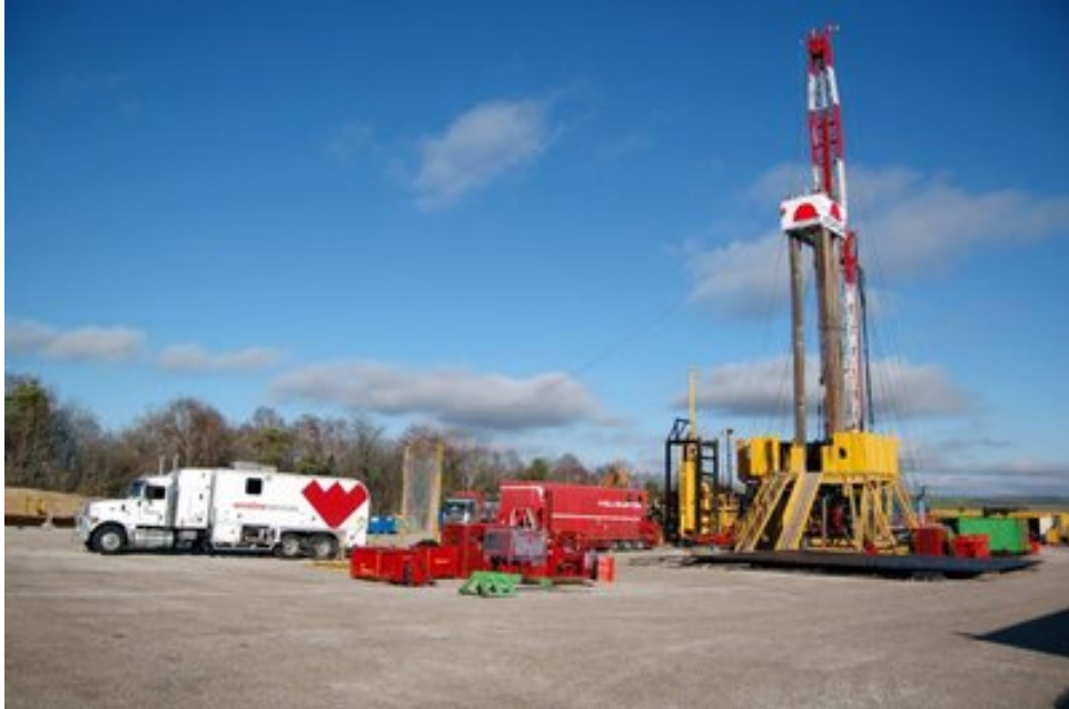
L'exploitation de l'huile de schiste nécessite des forages horizontaux de plusieurs km de long et fait débat. Archives - Isabel Da Silva
